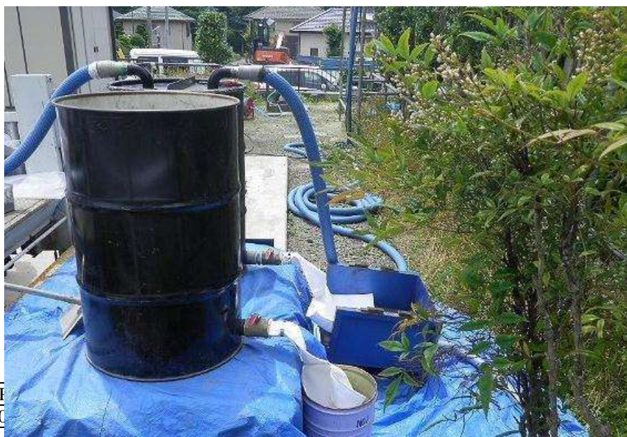
Gambar 33. Contoh pengolahan air limbah (pengendapan menggunakan tangki air)
