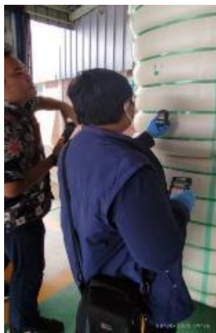
Gambar 21. Pengukuran Paparan Radiasi di Gudang Bahan Baku
