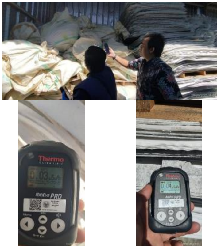
Gambar 24. Pengukuran Paparan Radiasi di Tempat Penampungan Limbah Padat Hasil Produksi
